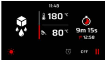
**!** عند استخدام مسبار قياس درجة الحرارة فإنه يتم إظهار حقل إعدادات الضبط في الأسفل، وتنتهي عملية التسخين عند الوصول إلى درجة الحرارة المضبوطة والمحددة للمسبار.
